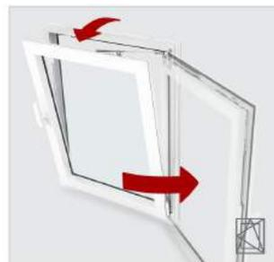
ABERTURA DE ATÉ 180 GRAUS PARA VENTILAÇÃO E LIMPEZA.
